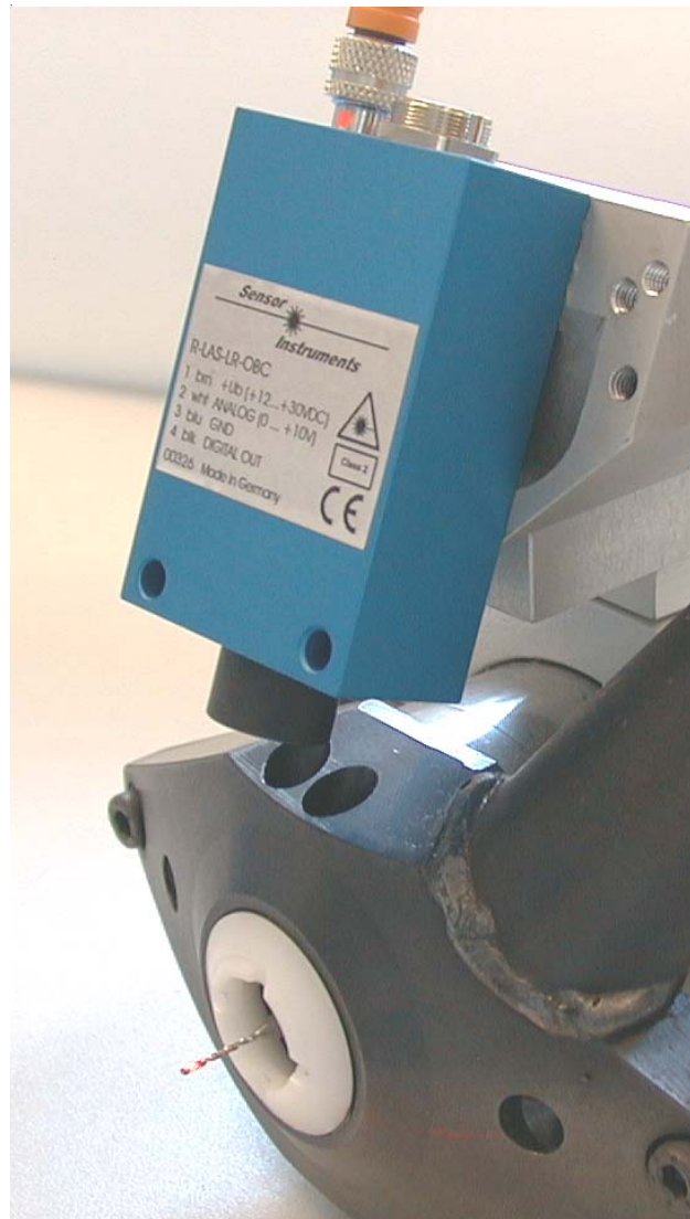
Lasersensor montiert auf einen Bohrerkopf
