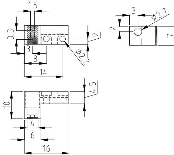
(Alle Abmessungen in mm)
