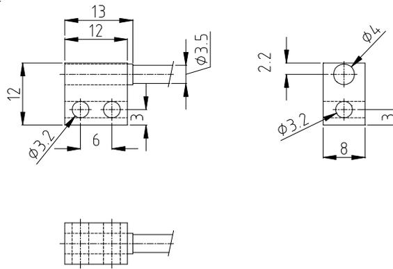
(Alle Abmessungen in mm)
