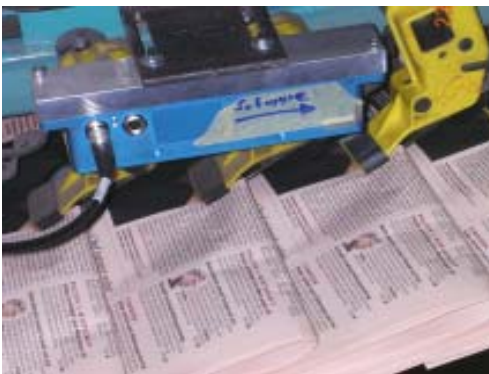
Abb. 5 und 6 Exemplarzählung während Überkopfförderung (LCC-90, LCC-90-MA)
