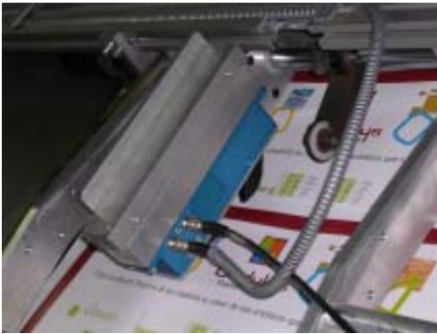
Abb.1 Kantendetektion von Laminaten (LCC-30, LCC-30-MA)
