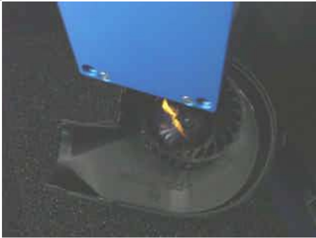
Erfassung der Drehzahl von rotierenden Teilen
