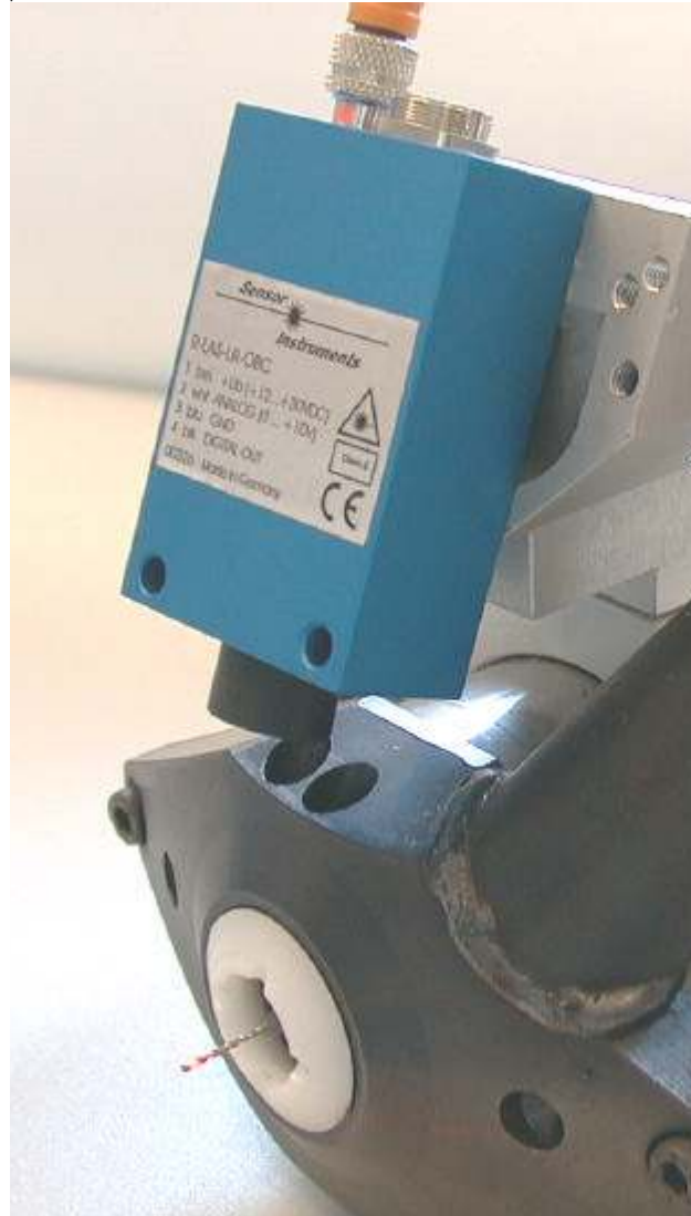
Lasersensor montiert auf einen Bohrerkopf
