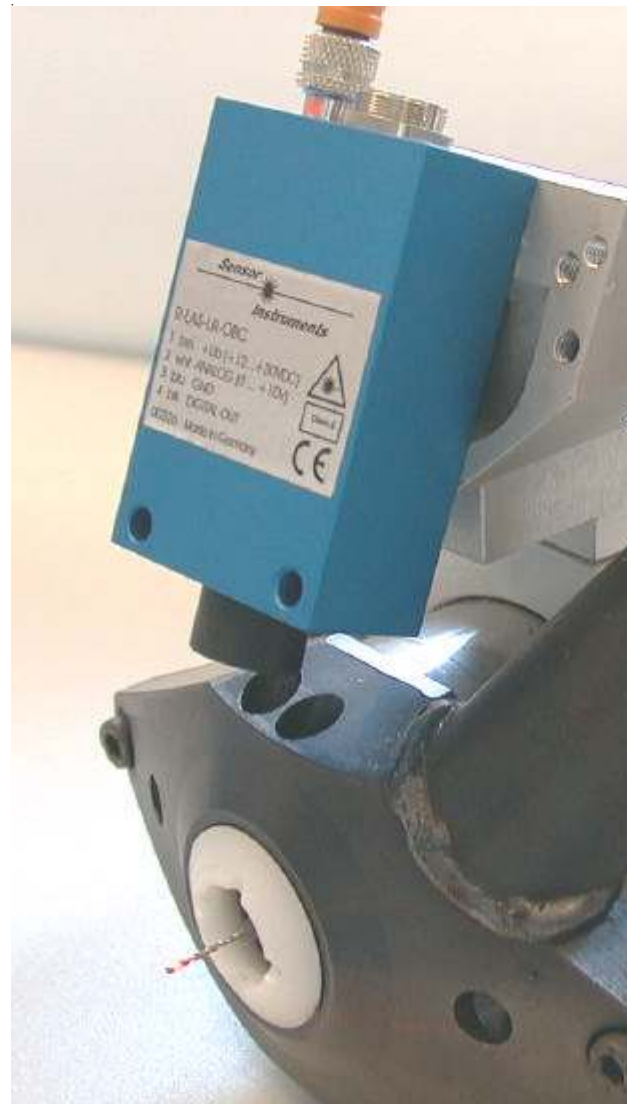
Lasersensor montiert auf einen Bohrerkopf
