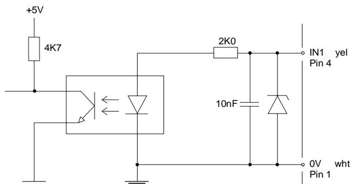
**Abb. 5: IN1-Synchronisationseingang für Messung TRIGGER (siehe Softwarebeschreibung)**
