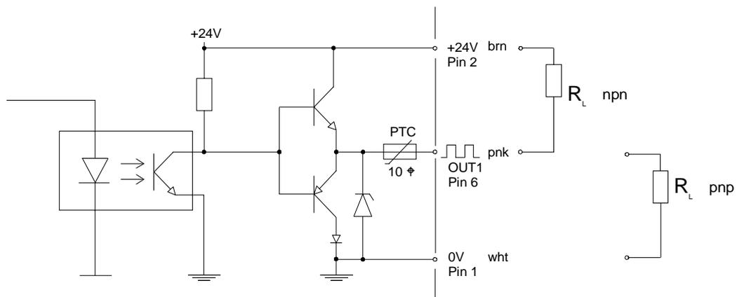
**Abb. 3: OUT1 - Ausgang 100 mA max. (Totzeit)**
