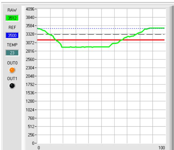
Wird der aktuelle Messwert **RAW** (grüne Linie) wieder größer als die Hystereseschwelle (schwarze Linie), dann wird auch der Ausgang **OUT0** wieder +24V (Signal ist in Ordnung). Dies wird über die LED **OUT0** visualisiert
