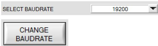
Unter **SELECT BAUDRATE** kann jetzt eine neue Baudrate ausgewählt werden. Durch Drücken von **CHANGE BAUDRATE** wird die neue Baudrate zum Sensor übertragen.
