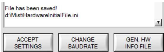
Über den Button **GEN. HW INFO FILE** wird ein File erzeugt, in dem alle wichtigen Sensordaten verschlüsselt hinterlegt werden. Dieses File kann zu Diagnosezwecke an den Hersteller gesendet werden.
