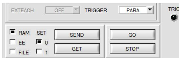
Der Zustand von IN0 wird auf der Oberfläche durch die LED **TRIG** angezeigt. Ist die LED schwarz, dann ist IN0=LO=0V und der Sensor arbeitet mit Parametersatz 0.
