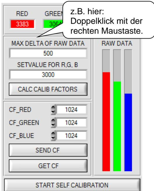
Um zur Offsetkalibrierung zu gelangen, muss in der Registerkarte **CALIB** ein Doppelklick mit der rechten Maustaste exakt auf den Rahmen gemacht werden.
