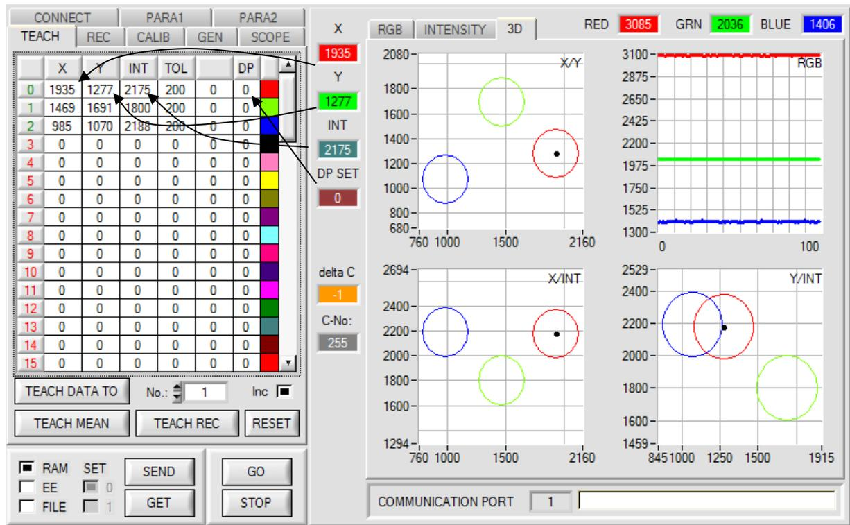
Drücken Sie nun wieder die Taste **SEND**, um dem Sensor die gelernte Farbe mitzuteilen. Aktivieren Sie den **GO** Modus wieder. Wenn der Sensor einen Zeilenvektor wiedererkennt (Farbe), wird die entsprechende Zeilennummer unter **C-No.:** auf der Software-Oberfläche visualisiert. Der Wert 255 bedeutet, dass keine der gelernten Farben wiedererkannt wurde.
