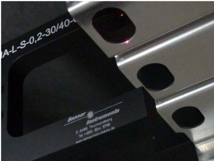
Posizionamento preciso della parte tranciata mediante barriera fotoelettrica a forcella FIA-L-RL
