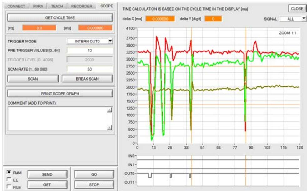
The SCOPE tab visualises an oscilloscope.
